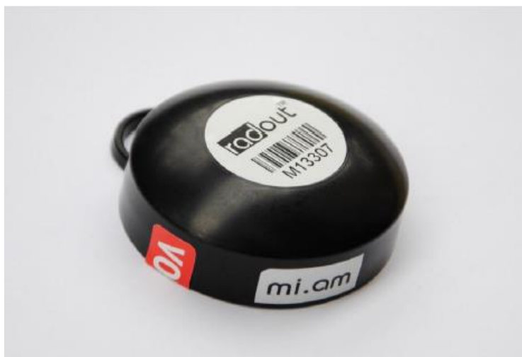
Figura 1. Dosimetro CR39 utilizzato per la misura nelle abitazioni
